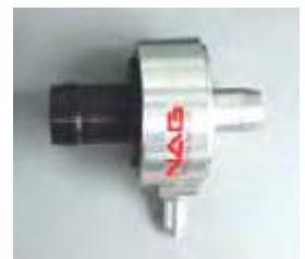
入口より出口(黒色部)を大きく設定したNAGバルブ
