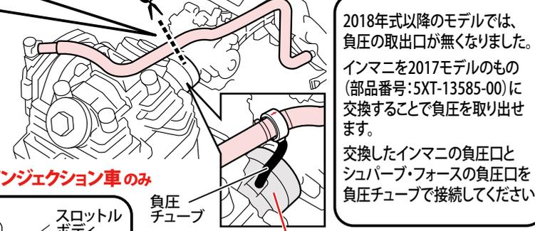
2018年式以降のモデルでは、負圧の取出口が無くなりました。インマニを2017モデルのもの(部品番号:5XT-13585-00)に交換することで負圧を取り出せます。交換したインマニの負圧口とスーパー・フォースの負圧口を負圧チューブで接続してください。
